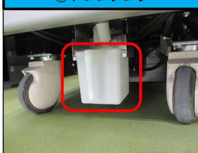
③ドレンタンク
