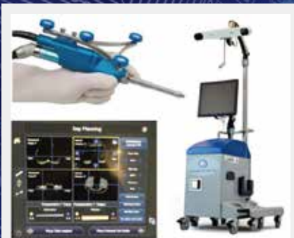
患者さんひとりひとりの病状 (関節形状・靭帯バランス) に合わせて人工関節手術を行うための手術支援ロボット
