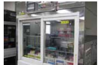
「赤血球製剤用保冷库」赤血球の機能を保つため輸血するまで4℃で保管します
